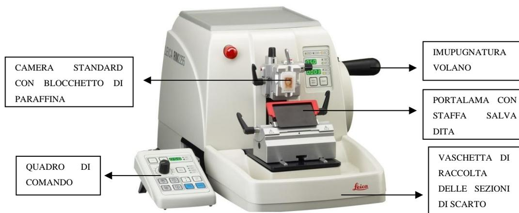
Figura 22: Microtomo rotativo Leica RM2255
