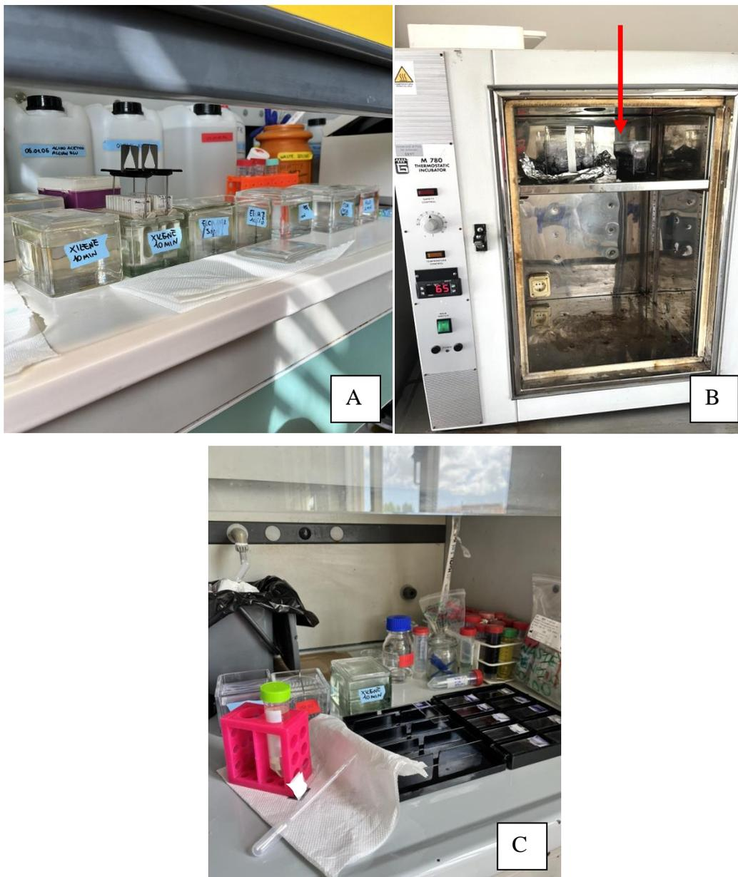
*Figura 25: Passaggi della colorazione Luxol Fast Blue. A: Passaggi sotto cappa chimica; B: Passaggio in stufa, la freccia indica l'alloggiamento dei campioni; C: Fase di montaggio dei vetrini.*
